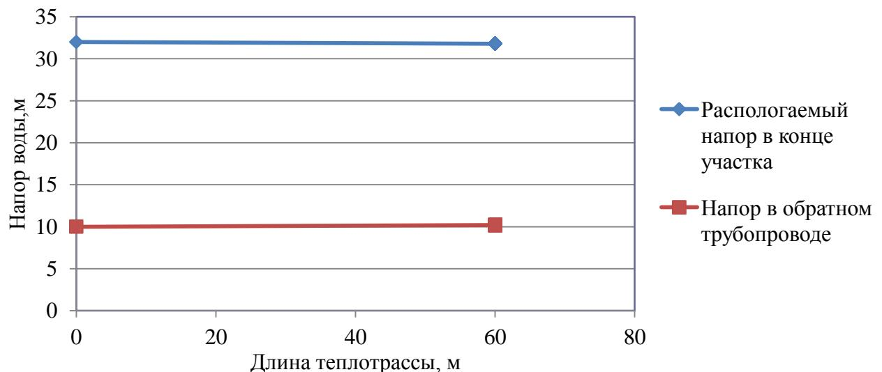
Рисунок 2.9 – Пьезометрический график тепловой сети котельной детского сада с. Нижнетобольное по второму магистральному выводу Котельная – здание администрации
