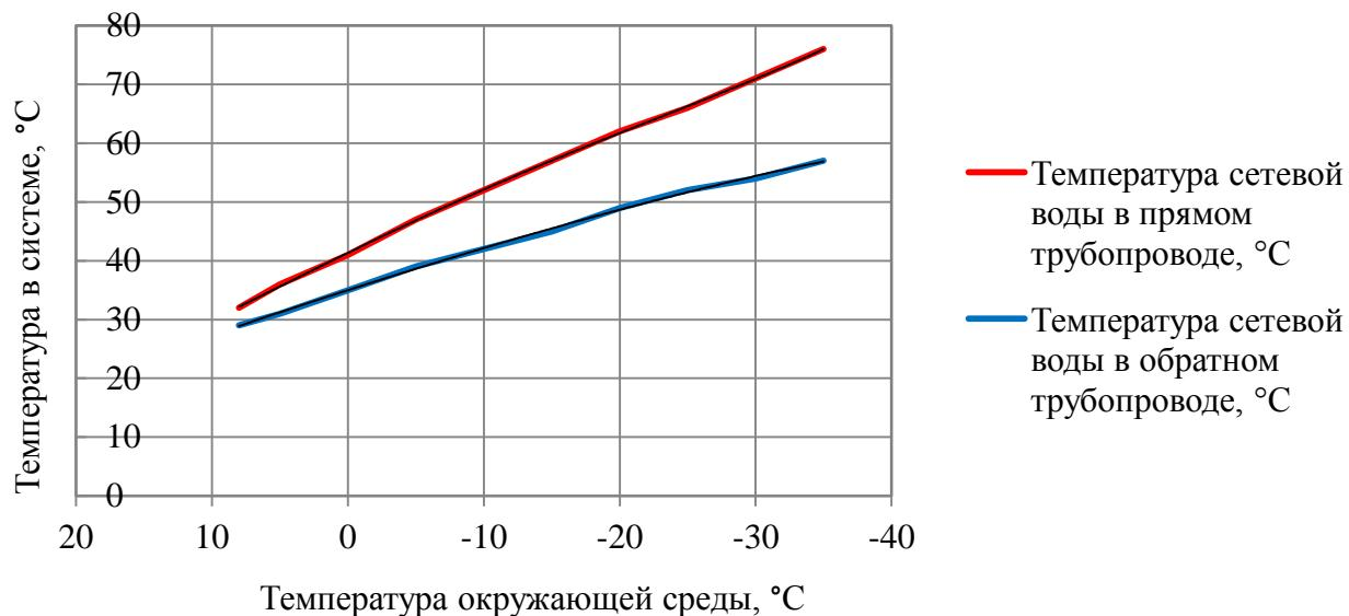
Рисунок 2.3 – График изменения температур теплоносителя
