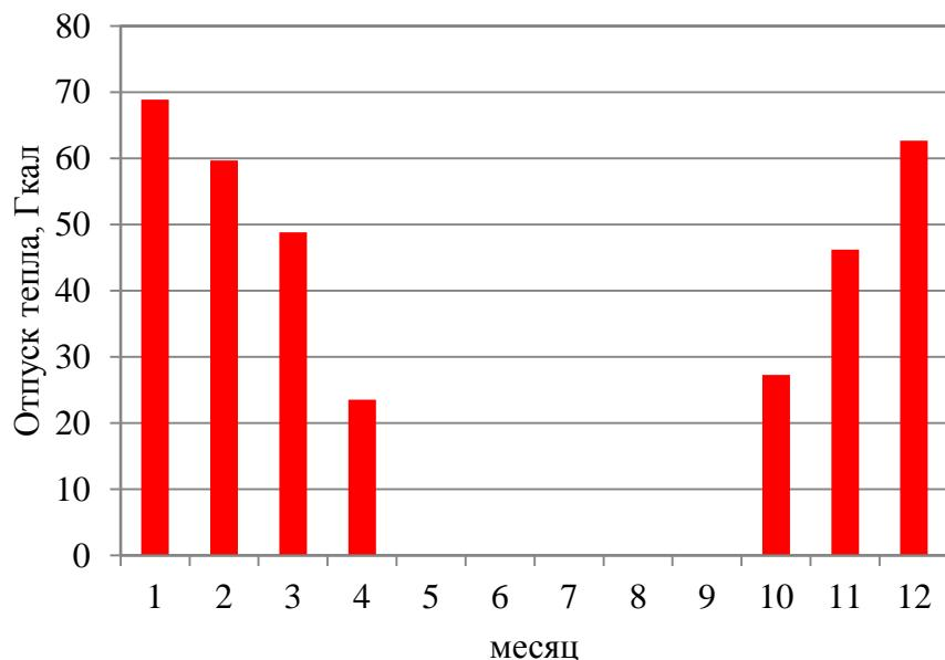
Рисунок 1.3 – Оптимальный температурный график отпуска тепловой энергии для школьной котельной с. Нижнетобольное
