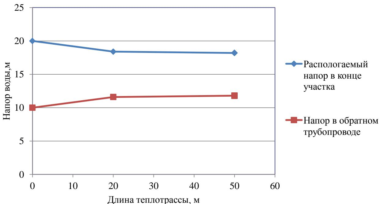
Рисунок 2.4 – Пьезометрический график тепловой сети школы с. Нижнетобольное
